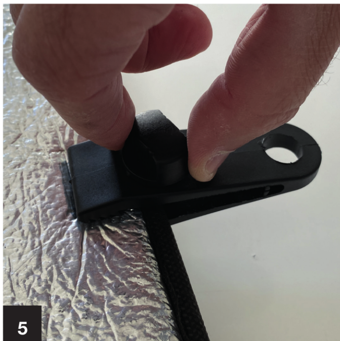
4 - Inserire i morsetti in prossimità dei ganci presenti nella parte bassa del container 5 - Stringere il morsetto utilizzando la vite presente
